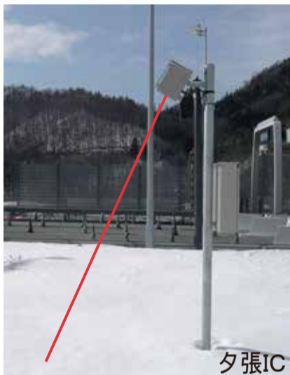
積雪面にレーザー光を照射のイメージ
